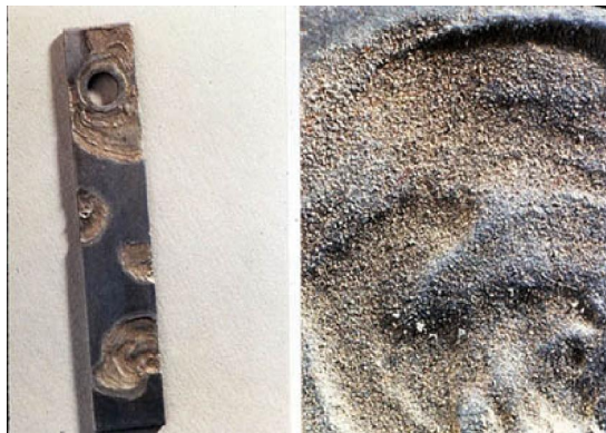
Hình 3: Ăn mòn bên dưới lớp vi sinh, rêu tảo
