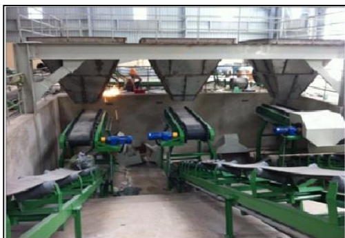
Công ty Supe lân Lào cai Hệ thống điều khiển 6 thành phần liệu cân bằng tải
