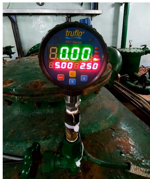
Đo áp suất điện tử cho nhà máy thủy điện
