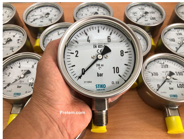
Hình ảnh đồng hồ đo áp suất đo (Gauge Pressure). Khi đặt ngoài khí quyển, kim đồng hồ hiển thị ở số 0
