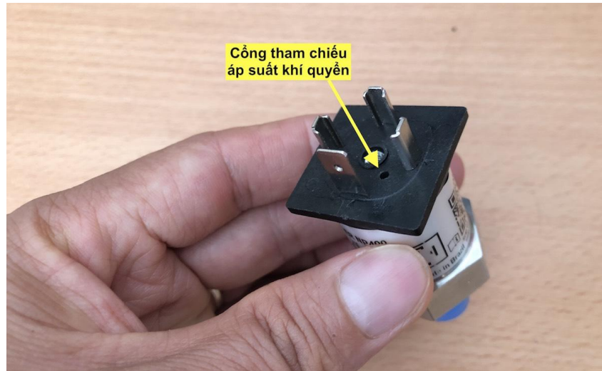
Cổng tham chiếu áp suất khí quyển trên cảm biến áp suất của Novus - Brazil
