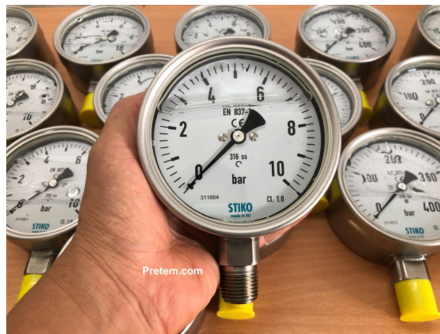
Hình ảnh Đồng hồ áp suất có dầu (glycerine) bên trong mặt đồng hồ để giảm rung kim
