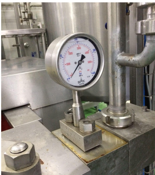
Đo áp suất máy đồng hóa kem
