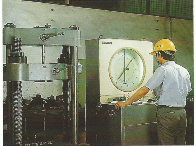
▲ 拉伸試驗 Tensile strength testing
