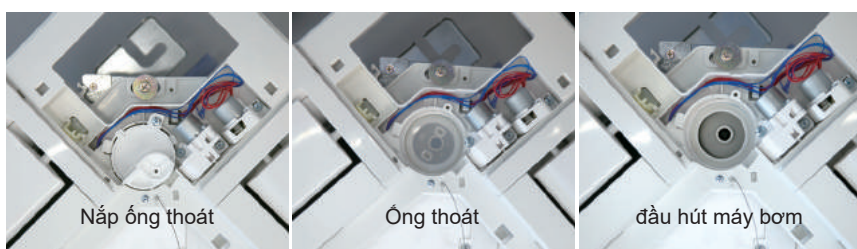
Tháo vỏ nắp thoát ra và kiểm tra. Nếu cần làm sạch, thì tháo nút cao su để thoát nước ra và tháo ống thoát nước ra.
