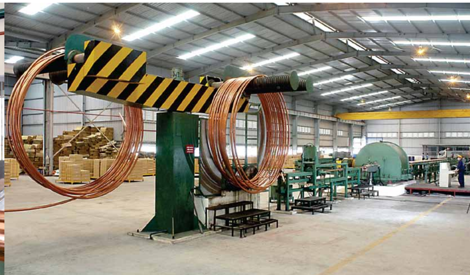
Máy cắt ống thẳng và cuộn PC - Straightening cutting and recoiling machine
