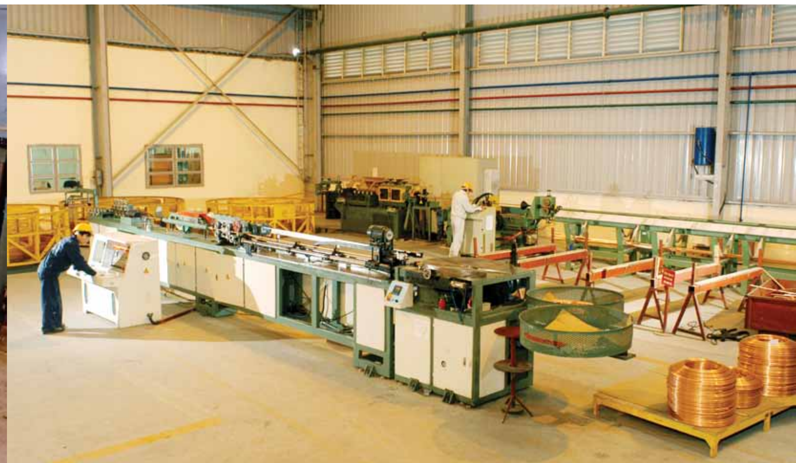
Máy cắt ống thẳng và cuộn PC - Straightening cutting and recoiling machine
