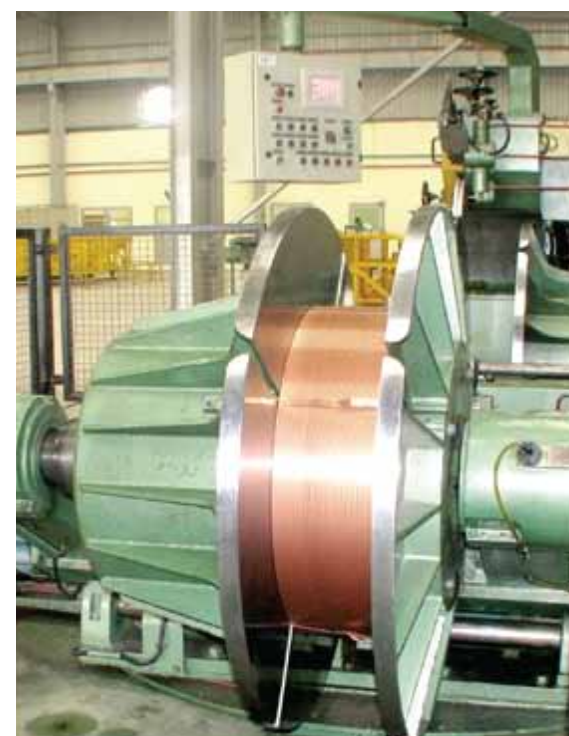
Máy cuộn ống LWC - Double head level winder
