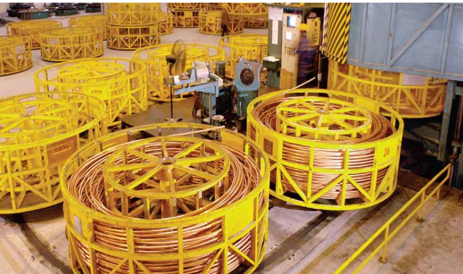
Máy kéo ống thành phẩm - Spinner block
