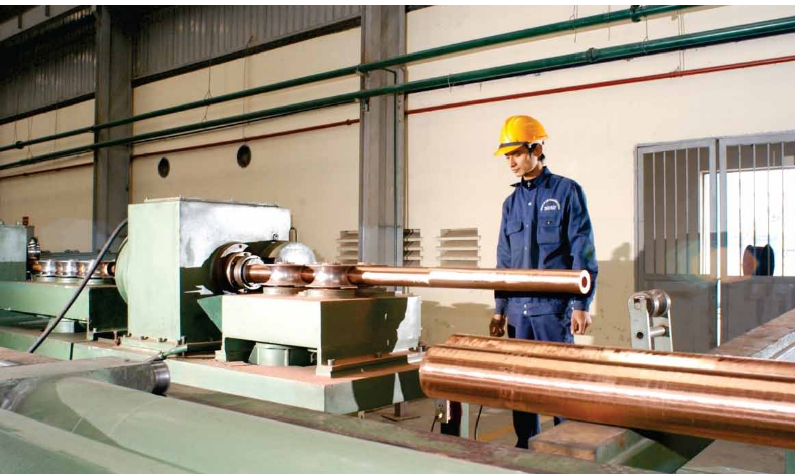
Máy kéo ống thành phẩm - Spinner block
